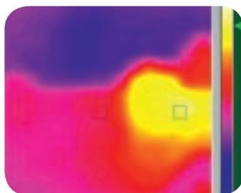
La TMTI 300 se utiliza para mostrar una diferencia de temperatura entre dos rodamientos en funcionamiento. Esta diferencia de temperatura podría indicar un problema potencial en los rodamientos que podría causar un fallo y una parada.
