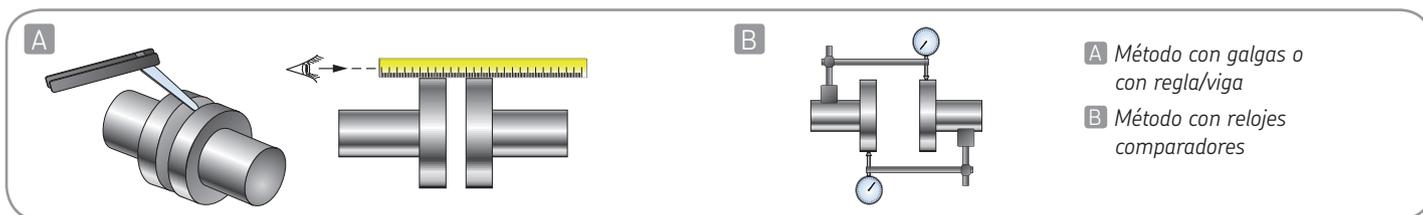
**A** Método con galgas o con regla/viga
